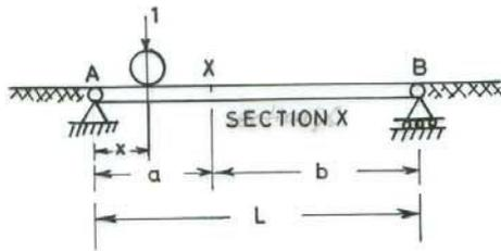
FIG. 11-1. ROLLING UNIT LOAD ON SIMPLY SUPPORTED BEAM
