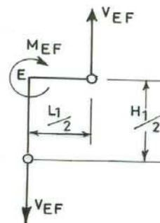
FIG. 18-23. FREE BODY DIAGRAM FOR COMPUTATION OF GIRDER MOMENT
