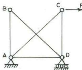
FIG.17-2. DETERMINATE TRUSS
