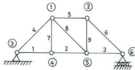
FIG. 9-4. JUST RIGID TRUSS
