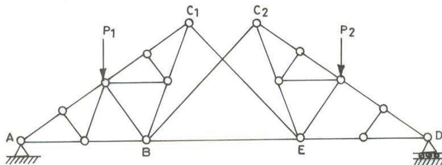
FIG. 9-10. COMPOUND TRUSS
