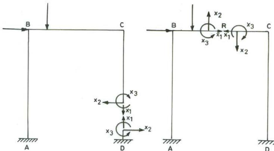
FIG. 6-7. CUTTING CLAMP/SUPPORT      FIG. 6-8. CUT IN BEAM
