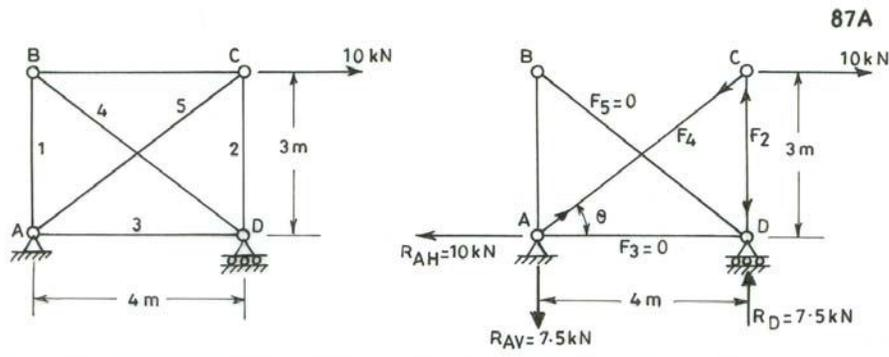
FIG. 17.15. INDETERMINATE TRUSS
