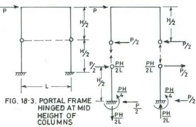
FIG. 18-3. PORTAL FRAME HINGED AT MID HEIGHT OF COLUMNS
