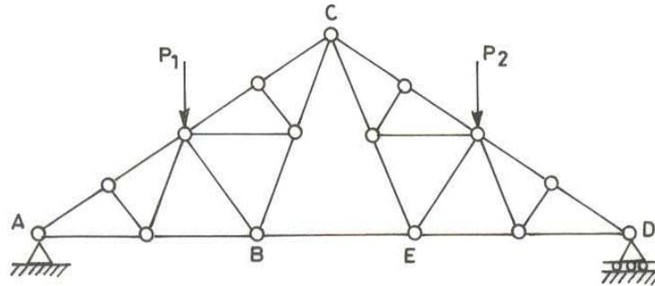
FIG. 9-8. COMPOUND TRUSS
