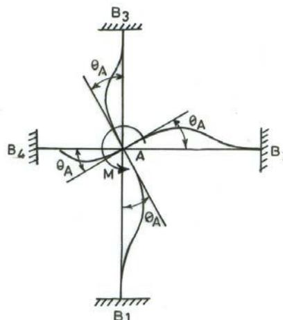
FIG.15-2. ROTATION AT JOINT A
