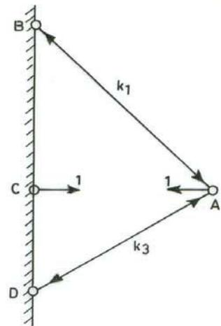
FIG.17-13. DETERMINATE TRUSS UNDER UNIT REDUNDANT FORCES
