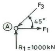
FIG. 9-14. FREE BODY OF JOINT A
